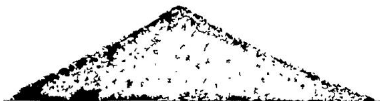
Hình F.3 - Cốt liệu bão hòa khô bề mặt; sự sụt đổ gần như hoàn toàn nhưng đỉnh xác định vẫn còn nhìn thấy và các sườn dốc có góc cạnh
