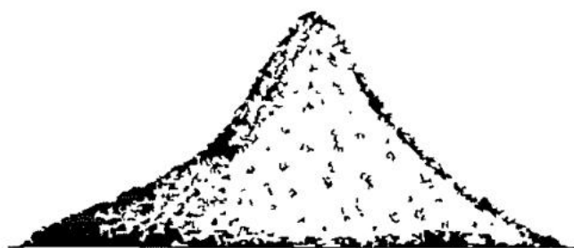
Hình F.2 - Cốt liệu hơi ẩm; sụt giảm đáng kể được quan sát
